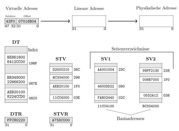
a) Die oberen 13 Bit des Selektors der virtuellen Adresse werden als Index verwendet, um einen der 8 Byte großen Einträge in der Deskriptortabelle zu selektieren. Geben Sie an, wie viele Einträge die Deskriptortabelle insgesamt enthalten kann und wie groß die Tabelle (in Byte oder kByte) maximal wird.
