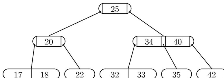
Dem Löschen von 22 folgt eine Balance-Operation.
