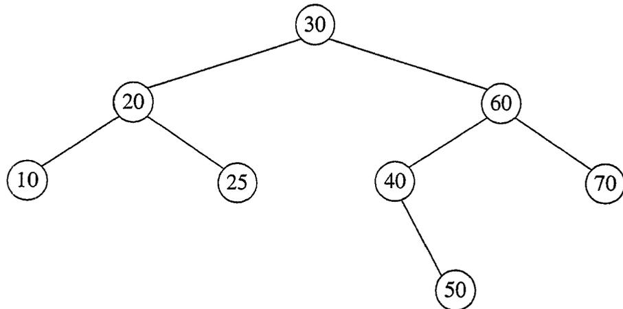
Fügen Sie nacheinander die Objekte 55, 58 und 45 in den Baum ein. Falls das AVL-Kriterium bei einer Einfügeoperation verletzt wird, markieren Sie den betroffenen Knoten und rebalancieren Sie den Baum unter Angabe des Verfahrens. Zeichnen Sie nach jedem Einfügen eines Objektes den Ergebnisbaum.
