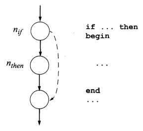
Wird eine If-Bedingung immer erfüllt, also der Then-Zweig immer durchlaufen, so bleibt die in der Abbildung gestrichelte Kante, die den Else-Zweig repräsentiert, unüberdeckt.
