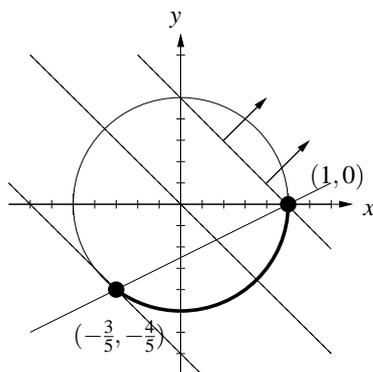
Interpretation: verschieben wir die Höhenlinien in Richtung des Gradienten (Aufstiegsrichtung) bis der mittels der Höhenlinie in Pfeilrichtung gebildete Halbraum nur noch einen Punkt aus dem Zulässigkeitsbereich enthält, so erhalten wir das Maximum an der Stelle  $(1, 0)$ .
