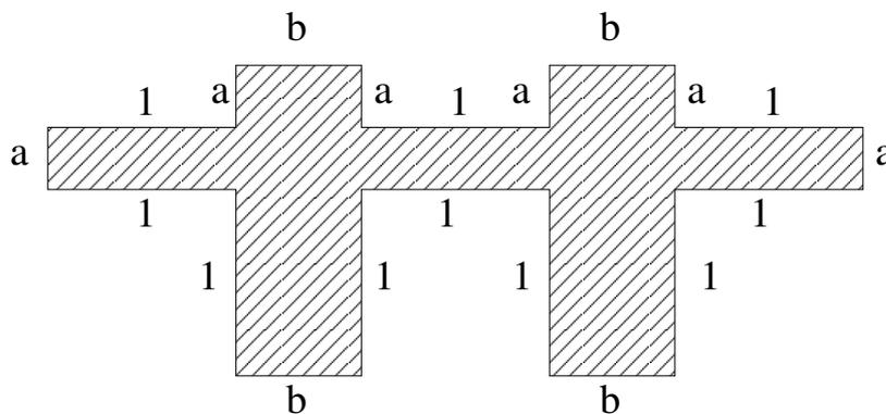
Die Kiste soll ein Volumen von  $a \cdot b \cdot 1 = 1$  umschließen und aus einem Faltpattern mit minimaler Fläche gebildet werden. (Wir nehmen an, dass wir den Verschnitt vollständig zu anderen Zwecken verwenden können.)
